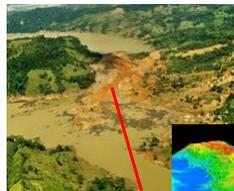
Uso del LIDAR para generar modelos digitales de elevación de alta resolución para el canal en San Juan Grijalva
