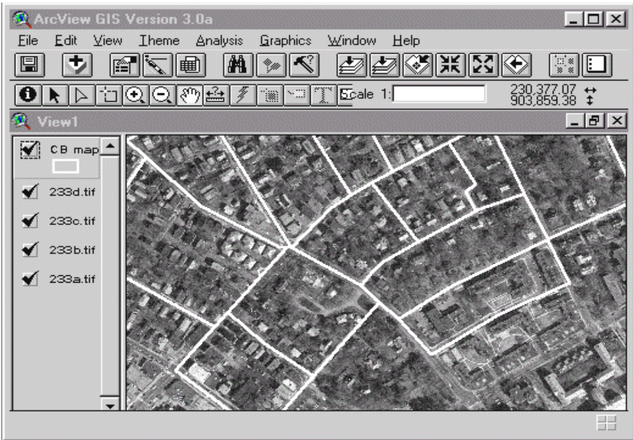
Рисунок II.22. Интерактивное определение границ счетных участков на цифровых ортофотоснимках
