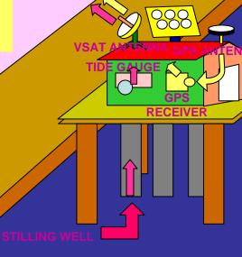
REAL TIME DATA TRANSMISSION FROM TIDE GAUGE STATION
